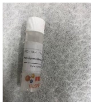
圖五、粒徑 10 μm 塑膠微粒
