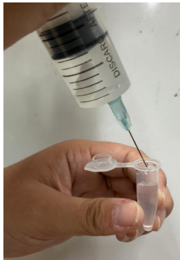
圖(二十五)使用針筒校正法將吸附後農藥以及氣凝膠分離
