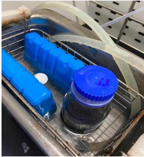
圖(七)將懸浮液放在超音波清洗機震盪
