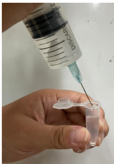
圖(二十三)使用針筒校正法將吸附後農藥以及氣凝膠分離
