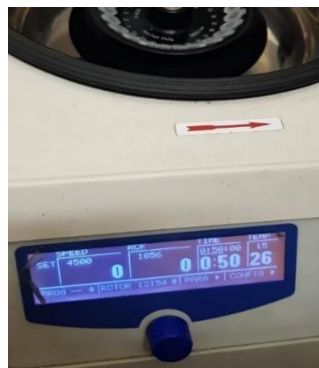
圖(八)將二硫化鉬奈米片層溶液放入離心機
