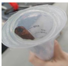
圖 2-14：質子交換膜固定於針筒開口及 PS 4 號塑膠罐底部開口的連接處
