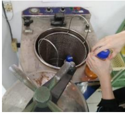
圖 2-1：將裝有 LB 培養液的 3 個血清瓶旋緊瓶蓋後稍微轉開，留有縫隙以利滅菌。
