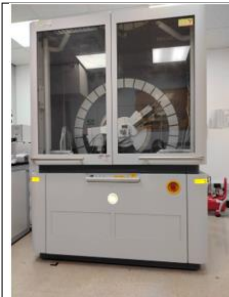
圖3(a) 我們使用的 XRD 繞射分析儀器機體
