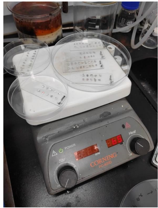
圖12 滴上檢測物之後烘乾(打開上蓋以便拍照)。
