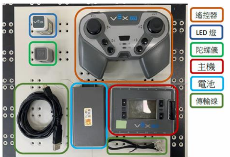
圖 8. 控制與感測器設備
