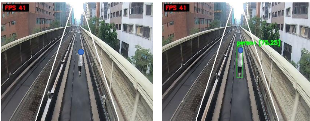
YOLOv4-Tiny，左圖 100 張照片、右圖 200 張
