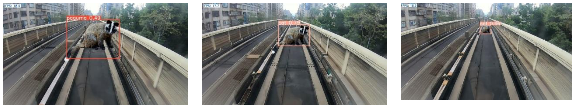
圖 94 比較 YOLOv6 S 版 物體在不同距離的辨識效果 (圖片來源：研究者自行拍攝)
