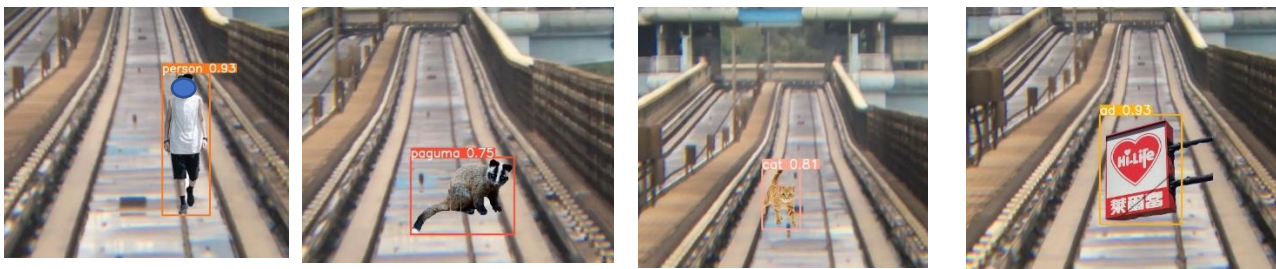
YOLOv6 N 版加望遠鏡頭辨識效果
