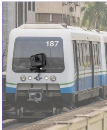
圖 33 模擬列車頭裝設攝影機 (圖片來源：研究者自行繪製、內湖線-維基百科)
