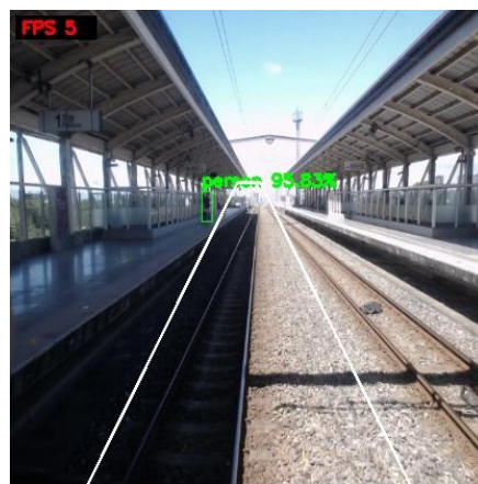
圖 105 YOLOv4 未限制辨識區域時， 可辨識到月台上的人 (圖片來源：研究者自行拍攝)
