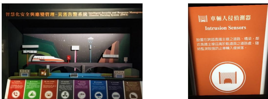
圖 55、災害告警系統 (DWS)：邊坡、洪水、雨天、地震、車輛、落石等告警系統。 (圖片來源：研究者自行拍攝)
