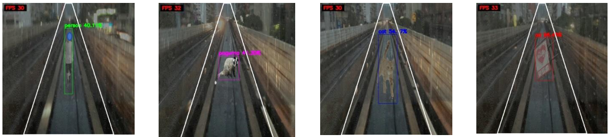
YOLOv4-Tiny 雨天辨識效果
