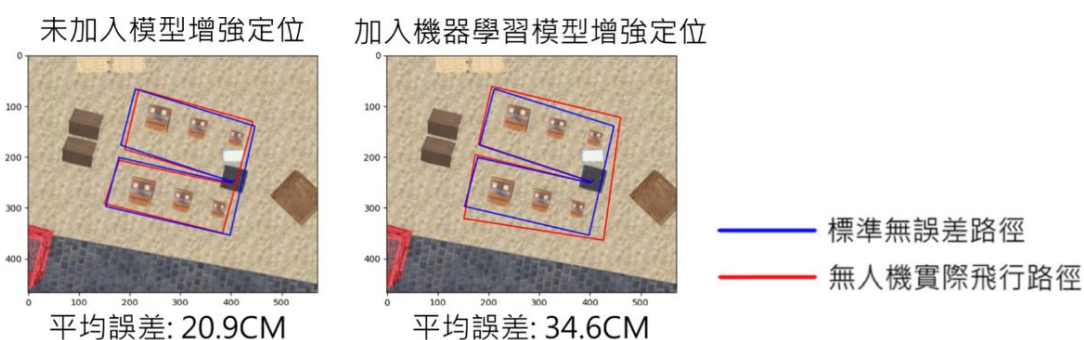
圖 23、無人機繞行於地圖外部之飛行路徑
