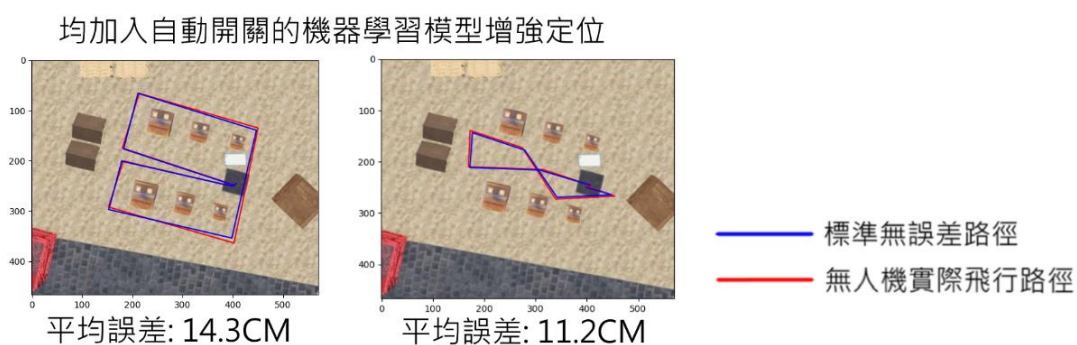
圖 24、加入機器學習模型啟用門檻後的無人機飛行路徑
