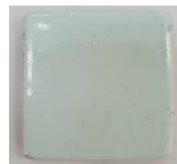
圖 17 微波燒製瓷土
