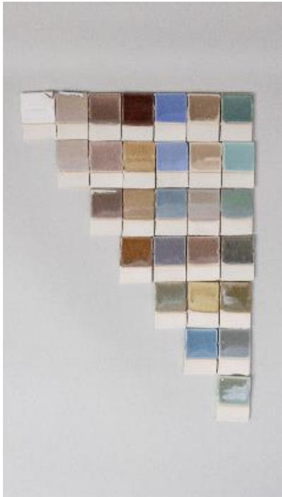
藉由多種氧化物的兩兩混合，觀察不同氧化物混合後所產生的變化。由下圖我們可以看到氧化鈷的顏色最不受其他氧化物影響，仍然保持藍色。交叉測試實驗能讓我們有系統性的混合不同的金屬氧化物，並且看出金屬氧化物互相影響的顏色變化，從而得知金屬氧化物在釉藥中影響和被影響的強弱程度。
