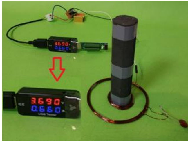
圖 5-27、本組所設計的電路，兩線圈距離 3 公分所感應的電壓及電流
