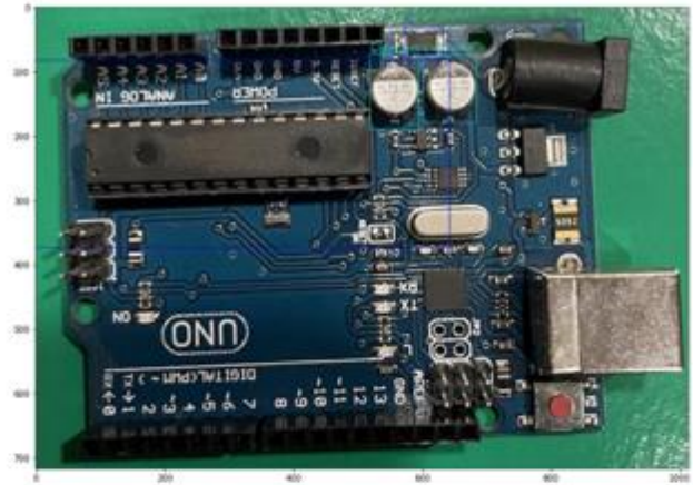
正確 IC*1 Capacitor*2
