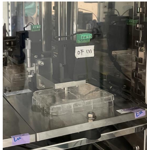
圖三、本實驗所使用的 cone flow device，透過調整速度與方向對時間的參數，可以給予細胞 UF 或 DF 剪應力。
