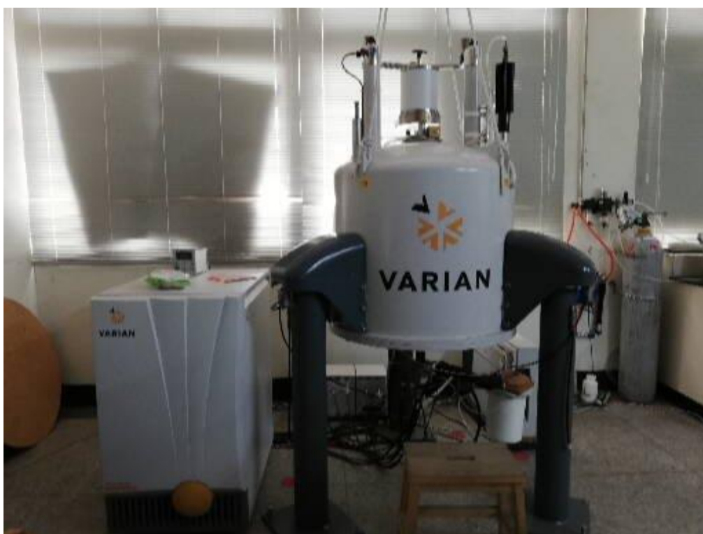
圖二、核磁共振儀(NMR)進行化合物結構測試
