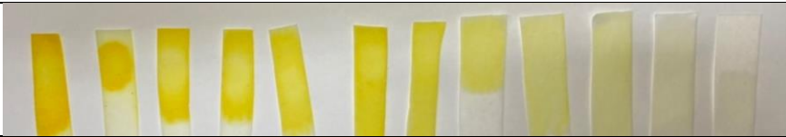
【圖】浸泡檢測液(硫酸鈦原液的 1/10)所製成的試紙上滴加不同濃度雙氧水 (1.6 M、0.8 M、0.4 M、0.2 M、0.1 M、0.05 M、0.025 M、0.0125 M、0.00625 M、0.003125 M、0.0015625 M、0.00078125 M)
