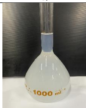
【圖】 千分之一倍稀釋的硫酸鈦檢測液產生混濁
