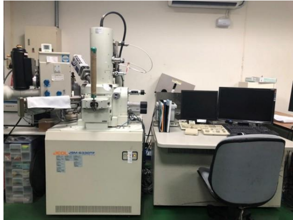
圖 2.4、掃描式電子顯微鏡(JEOL-6330TF)
