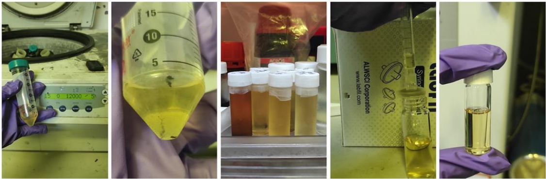
圖 9、以不同有機溶劑分離並收集不同粒徑之 cQD 的研究照片
