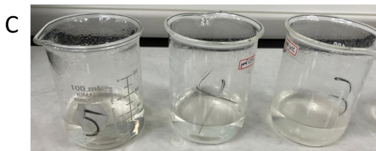
圖八、(A) 以改良式方法使 PLA 於高濃度氫氧化鈉中降解 (B) PLA 於高濃度氫氧化鈉中完全降解 (C) PLA 完全降解情形
