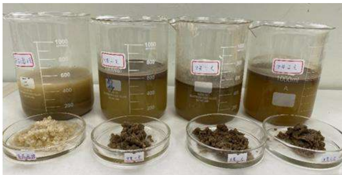
▲圖 3-5 酵素處理後的魚骨與濾液 資料來源：學生拍攝。
