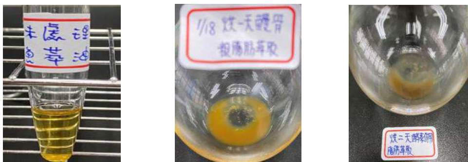
▲圖 4-4 未處理鰻骨、烘乾前處理、酵素前處理之萃油比較（左至右）
