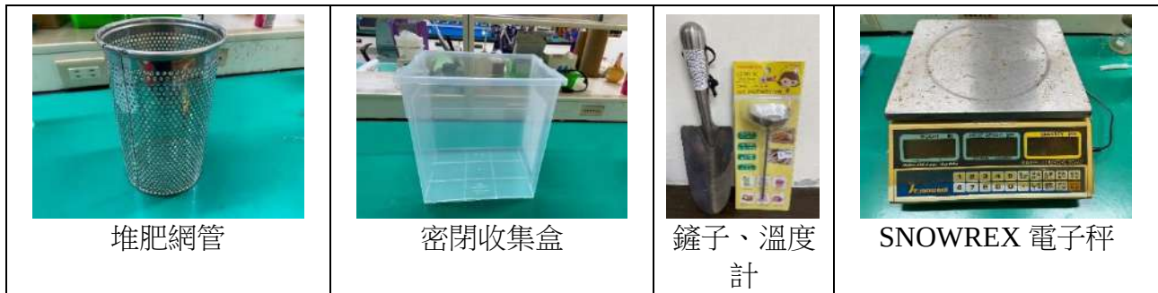
圖 3-2：堆肥管設備及儀器(資料來源：圖 3-2 作者自行拍攝)
