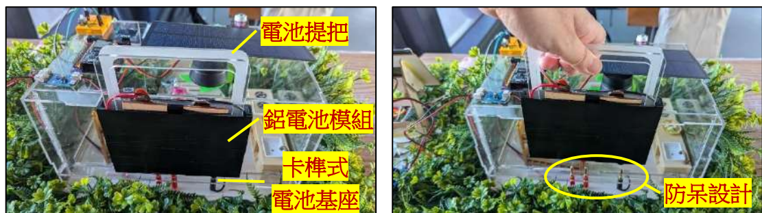
圖 3-3-9-5 可抽換式鋁電池在太陽儲能屋的裝設圖(左為通電中，右為拔起更換)
