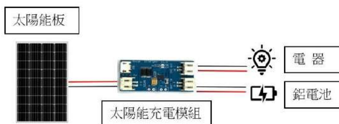
圖 3-3-9-1 利用太陽能板對稻殼鋁電池進行充電的實驗架構示意圖 (照片由第二作者繪製)
