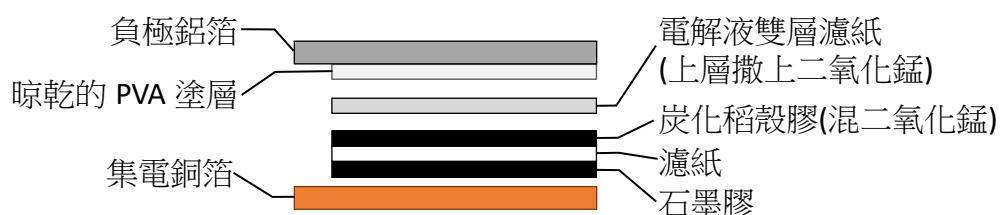
圖 3-3-8-1 自製炭化稻殼紙/鋁電池的示意圖(此圖由第一作者繪製)
