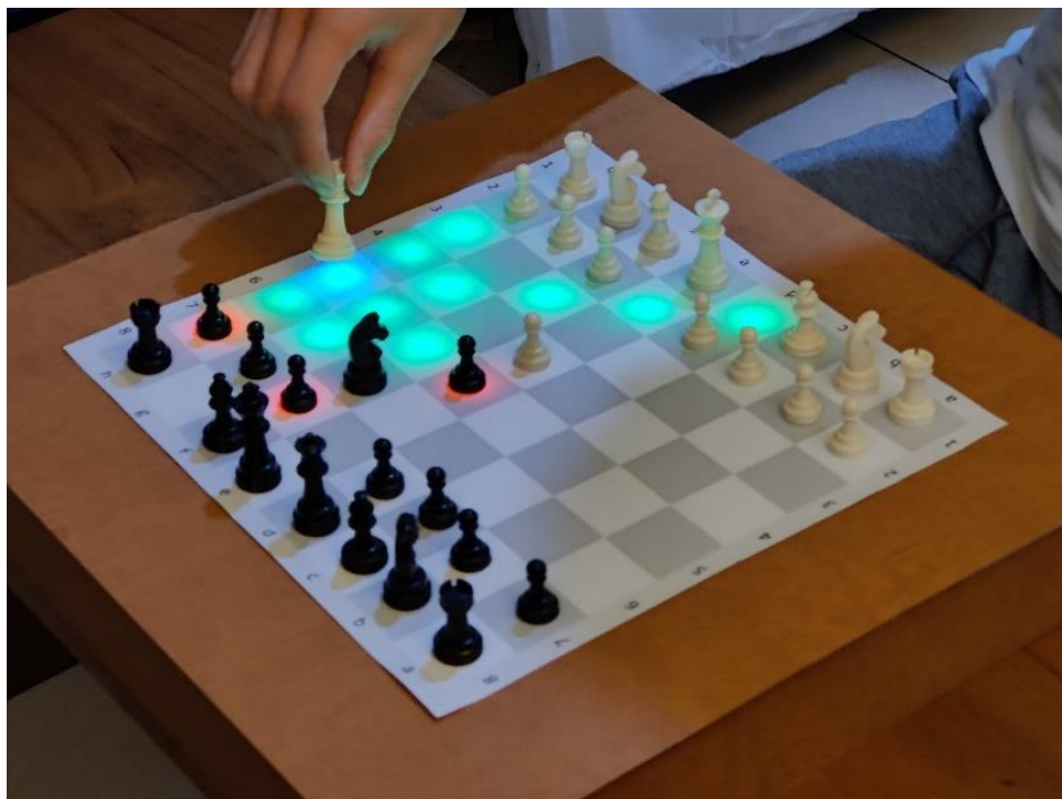
圖十八：智慧棋盤組裝完成品（資料來源：研究者自行拍攝）
