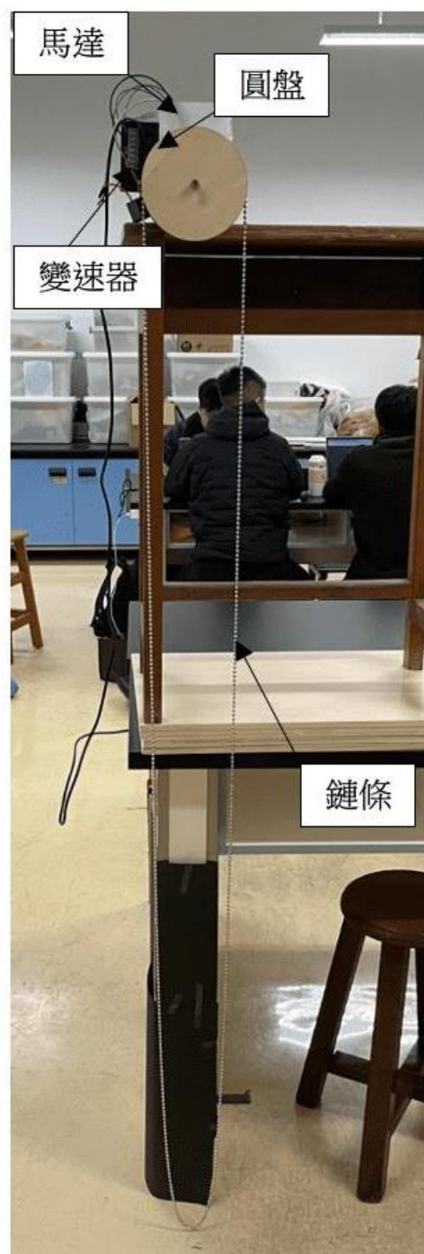
圖 1-1 和 1-2、實驗裝置架設圖，側視圖與正視圖(註:自行拍攝)
