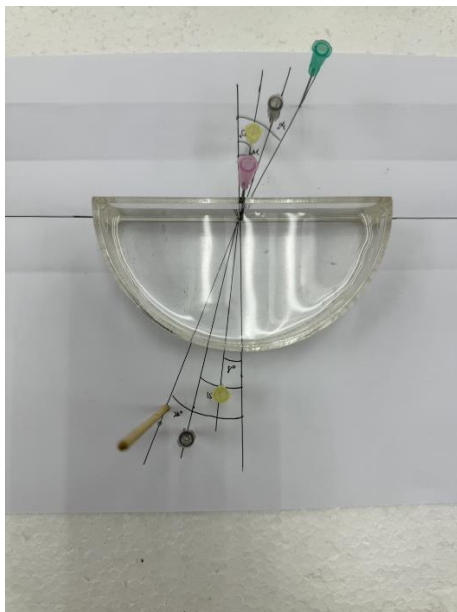
(圖 7-2 此為水的折射率測量)
