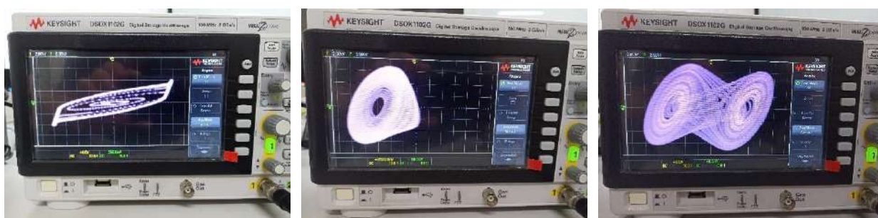
圖 5-3-8 不同參數 \beta 下蔡氏電路的三種模式（週期→單渦旋混沌區→雙渦旋混沌區） (研究者用示波器所模擬的波形圖)
