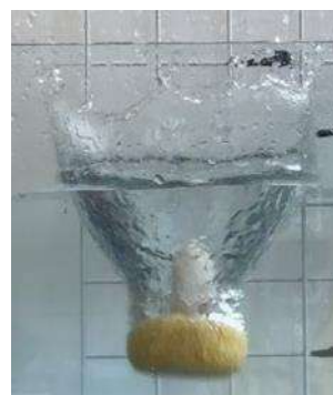
圖 5-1 本次實驗觀察到的隕石坑液面及周圍皇冠狀液滴（照片為作者自行拍攝）。
