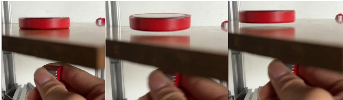
圖(二):兩磁鐵之間隔著一塊銅板。當下方磁鐵靠近上方磁鐵時，上方磁鐵會被往上推，隨即產生橫向位移並掉回銅板平面。(本照片為作者親自拍攝)
