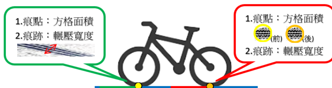
圖 2-1-2、壓痕面積量測示意圖(圖片來源:作者自行繪製)
