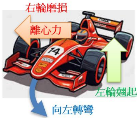
圖 3-4-4、平地左轉的汽車應左輪翹起 (圖片來源:作者自行繪製)
