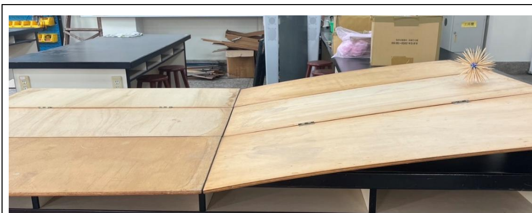
圖 9、摩擦力實驗裝置
