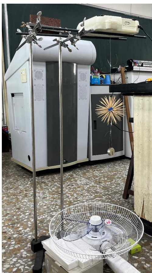
圖 10、風速與風力關係實驗裝置
