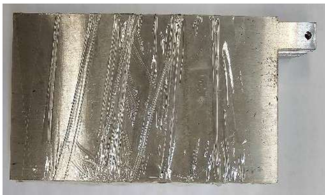
圖 13. 鉀離子電池的鋁板電極(鋁 1050，購自崇浩光電科技股份有限公司) (圖片由作者自行拍攝)
