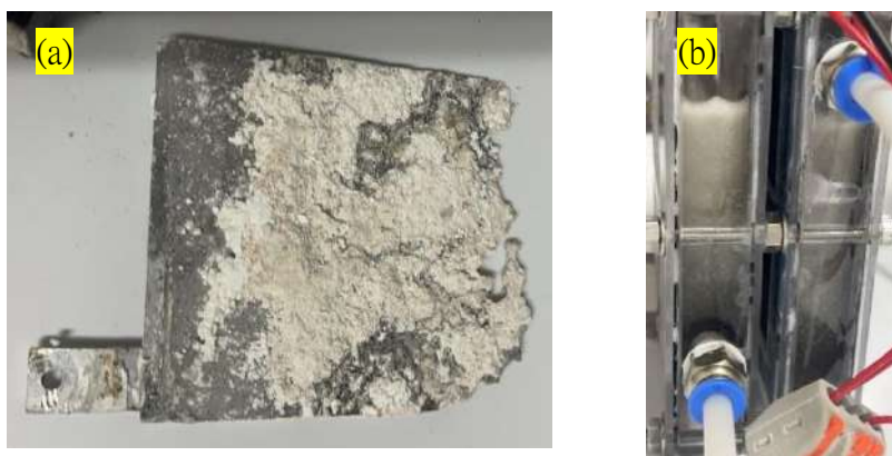
圖 20. 鉀離子電池的反應過程中產生的 (a) 氫氧化鋁沉澱，(b) 氫氣。(圖片由作者自行拍攝)
