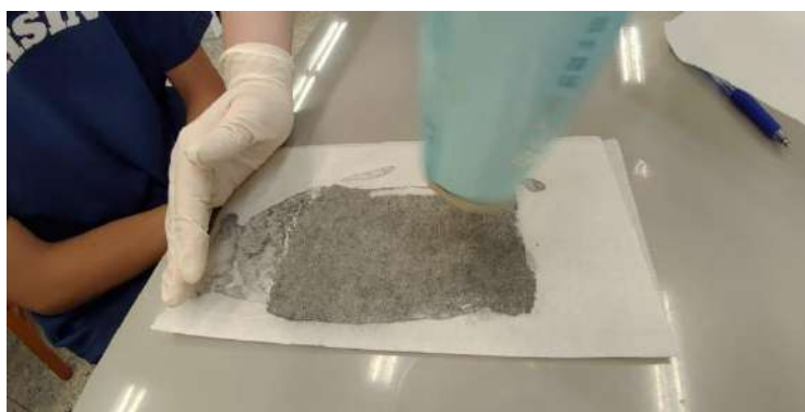
圖 16. 用熱風槍吹乾塗好漿料的碳電極 (圖片由作者自行拍攝)
