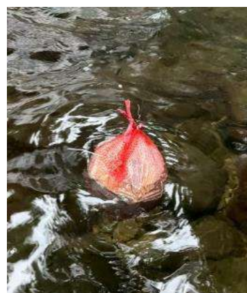
圖 3-1-2、透過塑膠袋包裹模組作為防水措施（作者拍攝）
