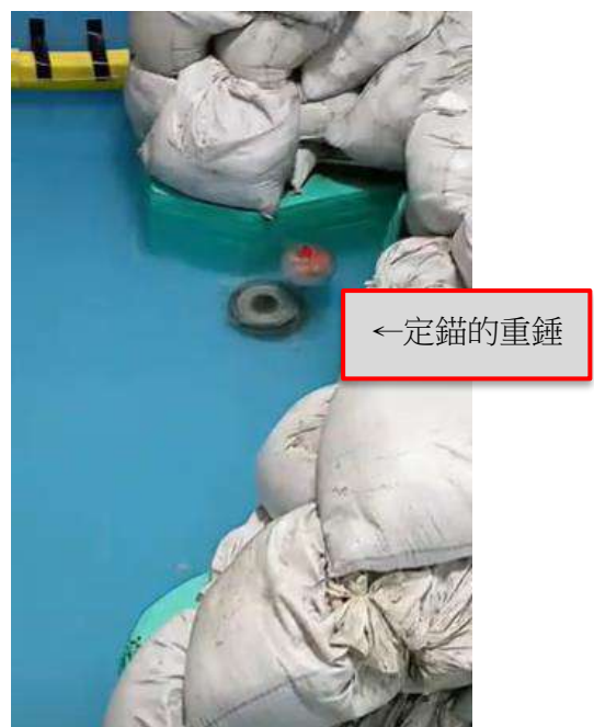
圖 4-3-3、水下 5 公分（定錨）監測實驗照片 （作者拍攝）
