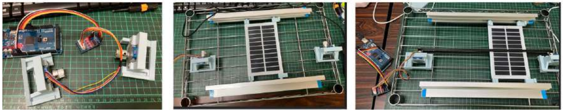
圖5、使用arduinoq控制步進馬達，用皮帶帶動太陽能板水平移動（自攝）
