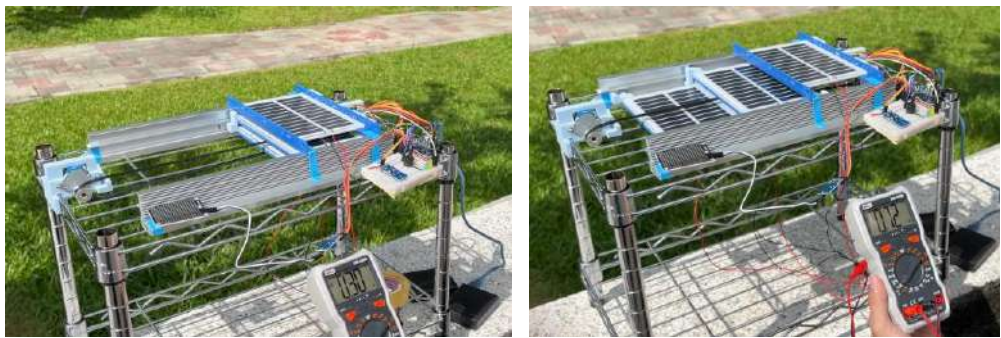
圖22、用三用電表測量發電電流，展開或閉內有很大差異（自攝）
