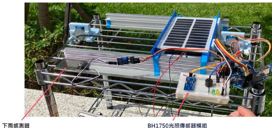
圖 12、系統增加下雨感測器和光照傳感器（自攝）
