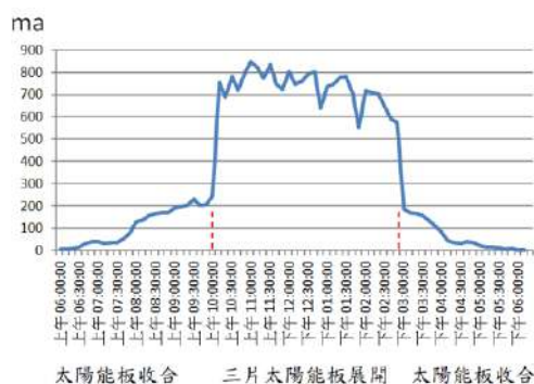
圖24、測量太陽能板未展開和11~15點展開之間的發電電流（自繪）
