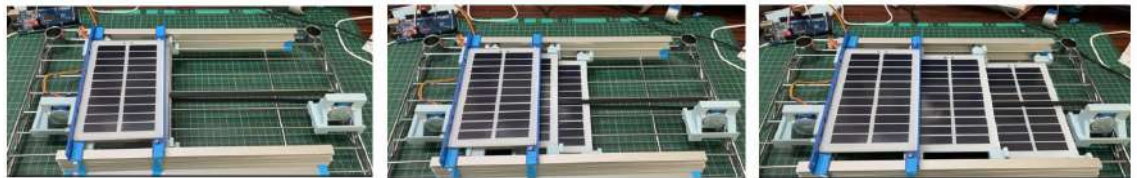
圖6、最上方太陽能板位置固定，最下方太陽能板為過動式（自攝）
