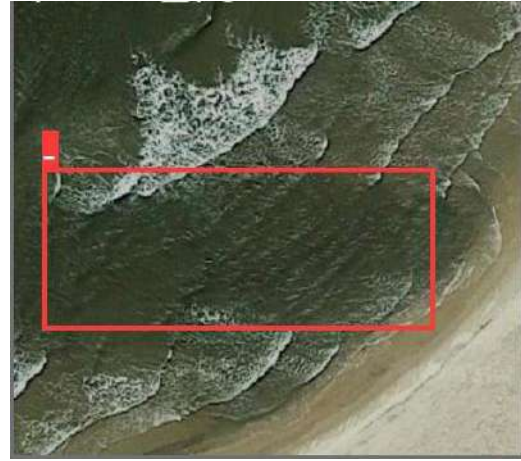
圖（二十七）辨識橫向角度之離岸流 （來源：本研究製作）
