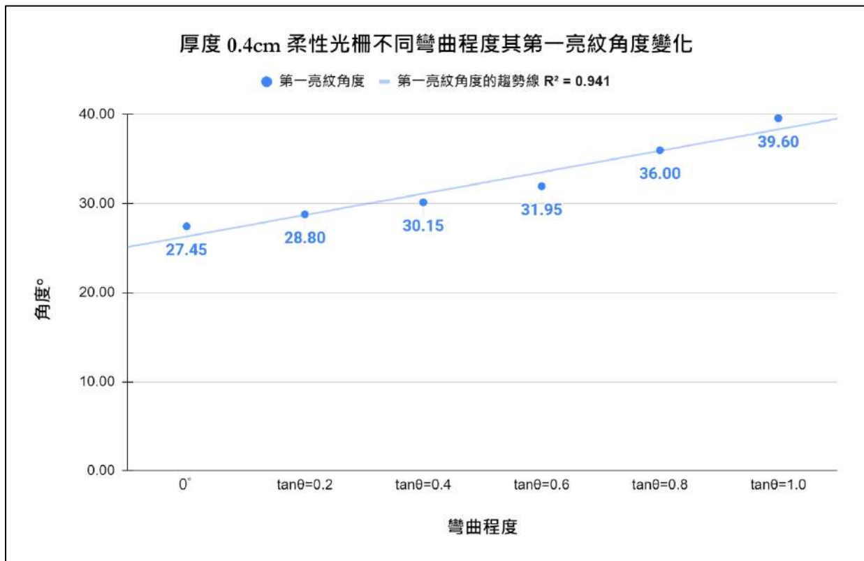
圖 33 柔性光柵不同彎曲程度其第一亮紋角度變化(厚度 0.4 cm 、彎曲角度 0^\circ \sim \tan\theta=1.0 )
