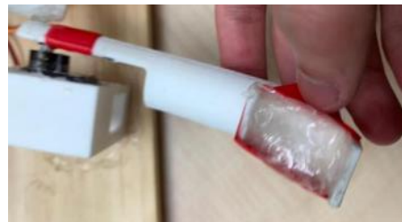
(b) 機械手指實際照片搭配密封材料
