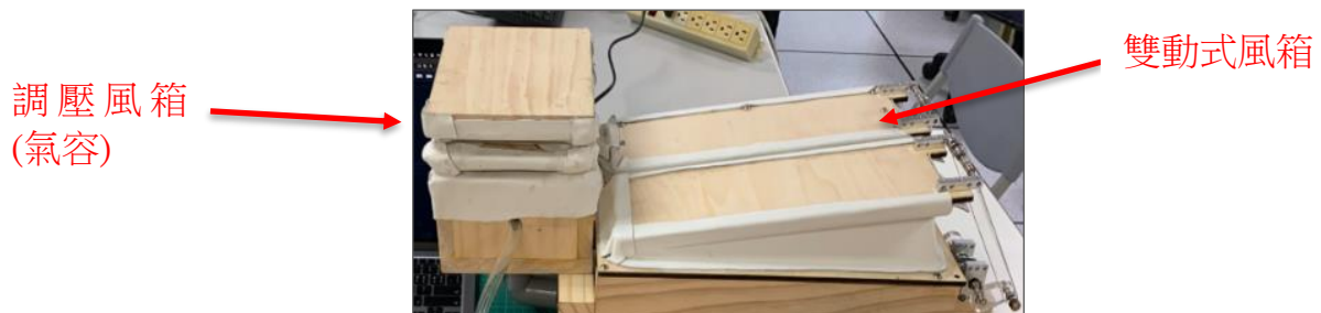
圖 14：雙動式風箱製作(圖片來源：自行擷取及拍攝)
