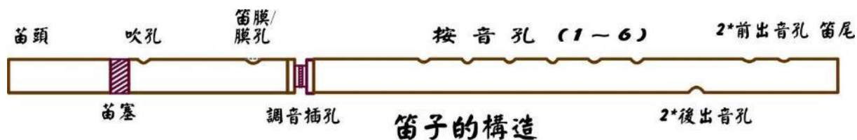
圖 2：竹笛的構造 (圖片來源：研究者自行繪製)
