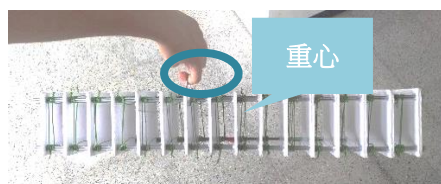
圖 17、懸吊法找重心-鋼筋大樓 (由第二作者拍攝)
