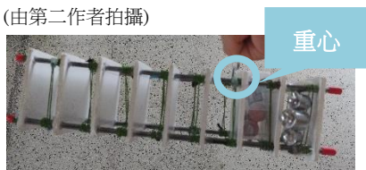
圖 19、懸吊法找重心-鋼筋華廈 (由第二作者拍攝)
