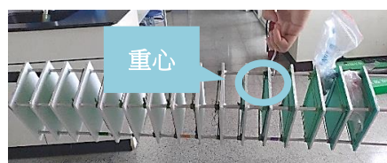
圖 18、懸吊法找重心-鋼骨大樓 (由第二作者拍攝)
