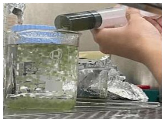
圖八、海藻酸鈉晶球擠出法之過程 (由作者於校內拍攝)
