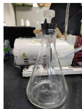
圖 2：抽濾裝置(側管錐形瓶及幫浦)(圖為作者拍攝)
