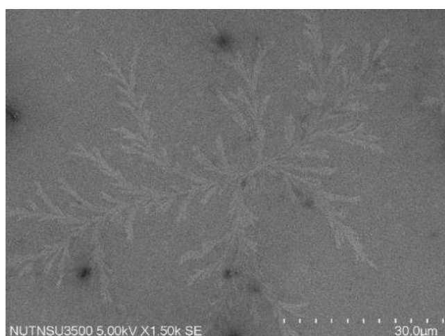
圖 27-以電沉積法製備時，意外發現在電壓 4 V、保護劑濃度 3：8、有法拉第波輔助下，會出現特殊的樹枝狀奈米結構。(作者製圖)
