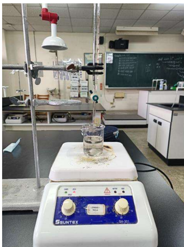
圖 3-化學還原法無法拉第波輔助之實驗裝置圖。(作者拍攝)
