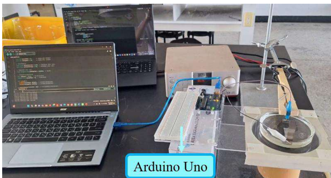
圖 2-電沉積法輔以法拉第波之實驗裝置圖(作者拍攝)
