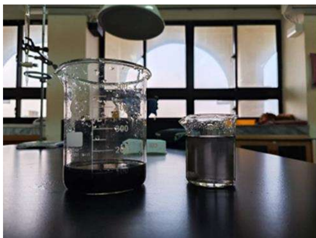
圖 7-兩圖中的左杯為法拉第波輔助，保護劑濃度 3：8 所得之奈米鎳粒子，右杯為沒有法拉第波輔助，保護劑濃度 3：80 所得之奈米鎳粒子。左圖為側視圖，右圖為俯視圖。經雷射觀察，兩杯都有明顯的廷得耳效應。(作者拍攝)
