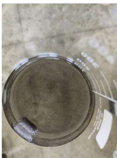
圖 8-兩圖皆為在無法拉第波輔助下，保護劑濃度為 3：8，製備出的奈米鎳。左圖可以發現所得金屬鎳，顆粒明顯大顆。右圖以雷射照射溶液，僅有燒杯邊緣出現廷得耳效應。(作者拍攝)
