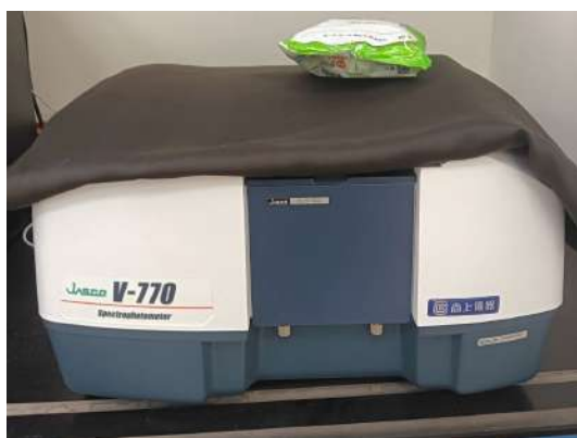
圖 1：紫外線/可見光(UV-Vis)分光光譜儀 主要用於測量物質在紫外線（190-400 nm）和可見光（400-800 nm）範圍內的光吸收特性。(研究者拍攝)
