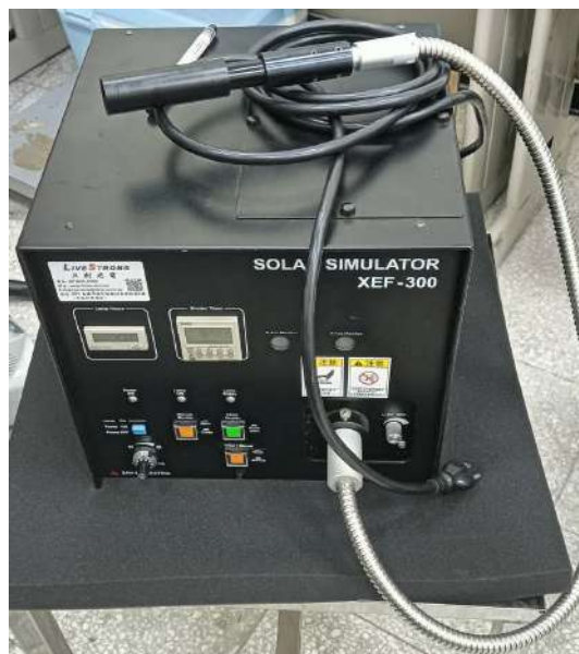
圖 4：光催化裝置 利用光能激發光觸媒的電子促進材料 進行化學反應的系統。 (研究者拍攝)
