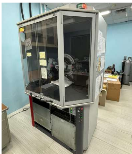
圖 3：XRD 儀器 研究材料在不同條件下（如溫度、壓力） 檢測材料的晶體結構和組成，並分析材料的 晶體缺陷和應力。(研究者拍攝)
