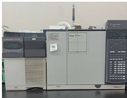
圖 2：氣相層析儀 GC system 分離和定量分析揮發性化合物。 (研究者拍攝)
