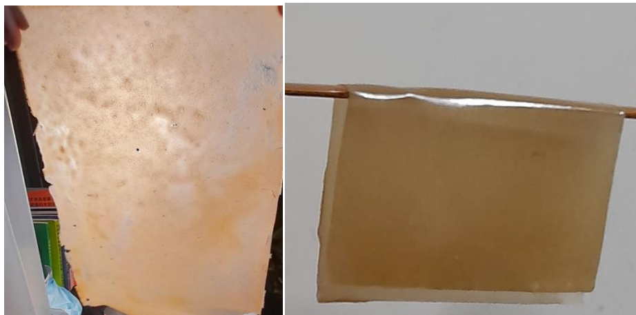
圖6 芋頭生物塑膠成品（B1配方）（圖片來源：親自拍攝）
