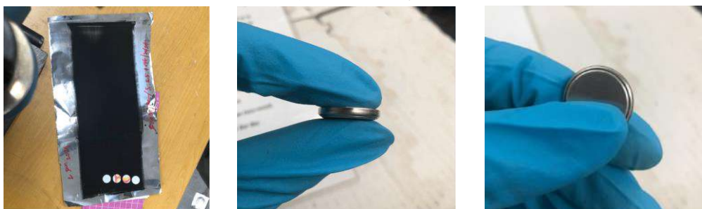
圖（九）、經塗佈機塗抹完樣品的陰極原料（左）、組裝完成的鈕扣電池（中、右）
