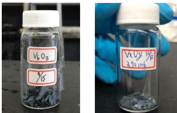
圖 (十一)、乾燥後收集起的 V_6O_{13}
