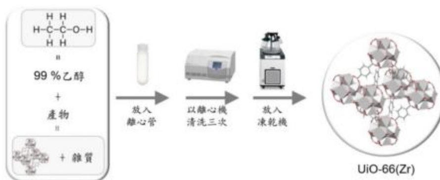
圖 4-4：清洗產物(UiO-66)之流程圖(圖片來源：作者繪製)
