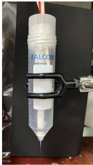
圖四、大氣電漿。電漿工作氣體為 Ar，電壓設定 7 kV，頻率 20 kHz，氣體流量 1 L/min
