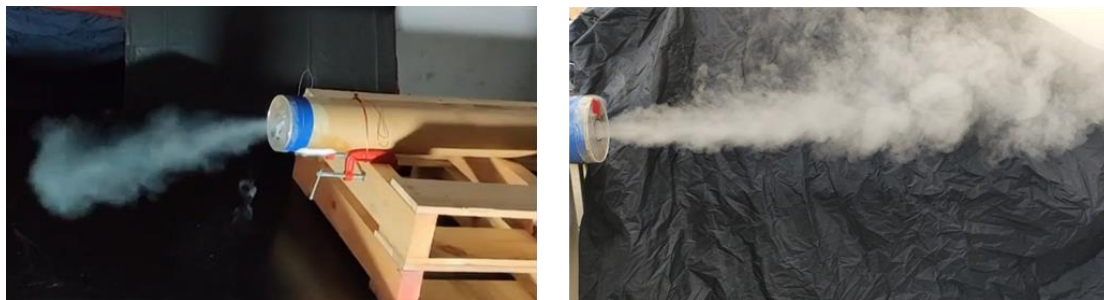
圖 4 利乾冰探討氣體流動情形/利用造霧器探討氣體流動情形
