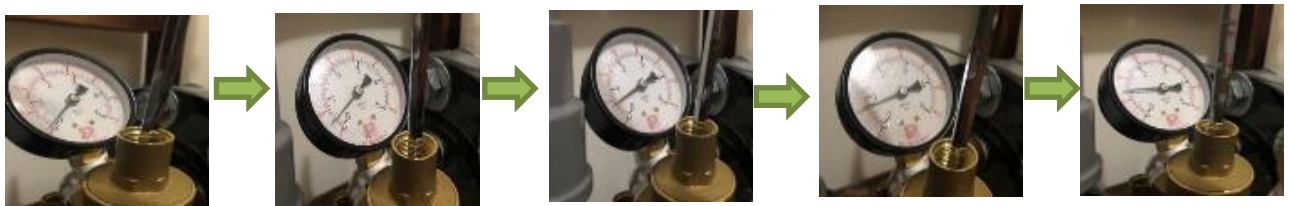
【圖 14】各調整減壓閥測試(每次調整 0.2 \text{ kg/cm}^2 )
