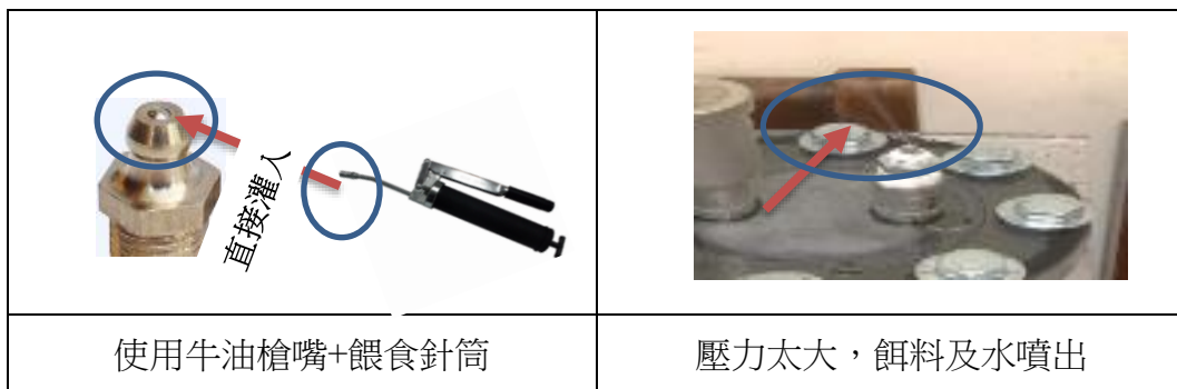
【圖 28】直接外來加壓方式投餌
