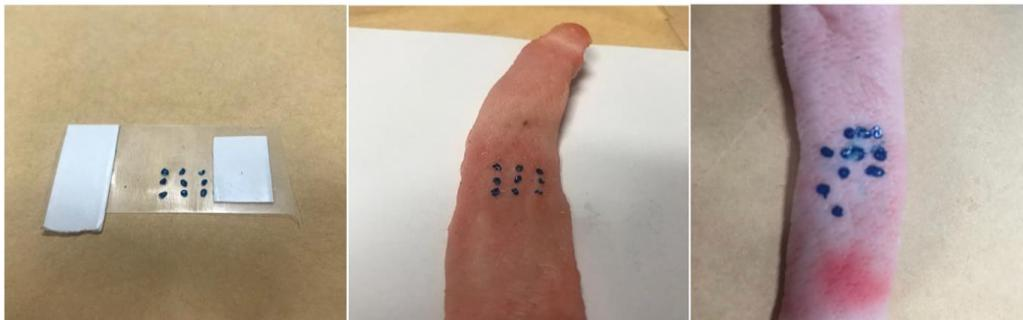
圖二十二、(左)將 3 X 3 蛋白質膠體陣列製作製造在經砂紙處理的塑膠基板上的結果、(中)成功將蛋白質膠體陣列轉移到豬皮上的結果、(右)將蛋白質膠體轉移到豬皮上陣列失敗的情況
