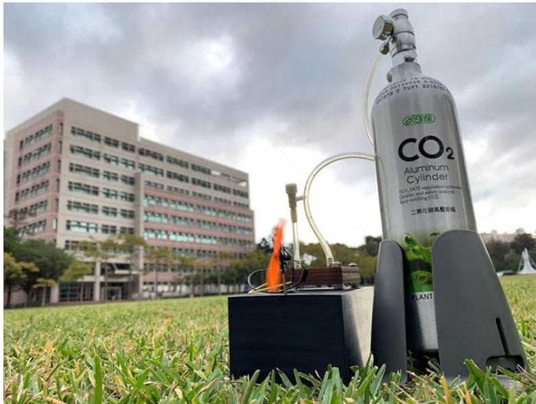
圖十二、鎂/CO<sub>2</sub> 燃料電池與二氧化碳鋼瓶組裝完成圖
