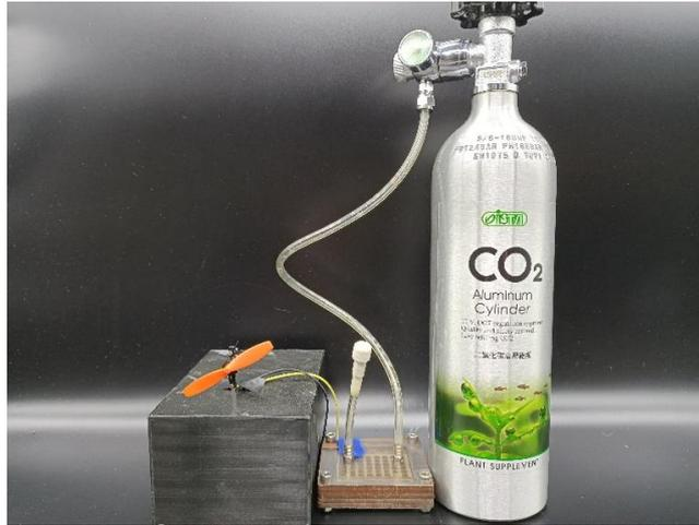
圖十一、鎂/CO<sub>2</sub> 燃料電池實驗操作圖
