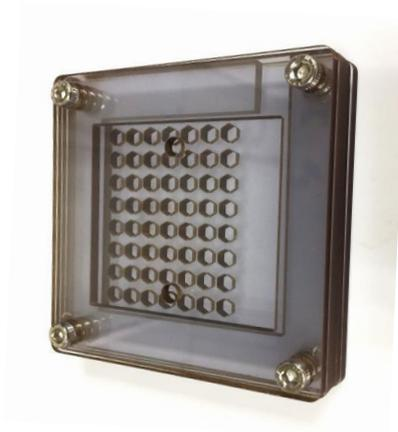
圖三、鎂/CO<sub>2</sub> 燃料電池側面圖
