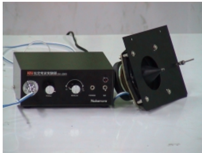
自製改良喇叭型振盪器
