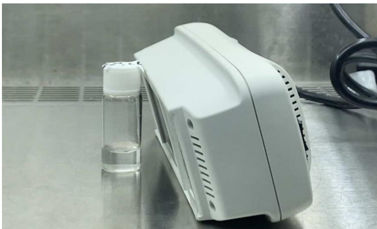
圖 38. 紫外光激發實驗，左邊為金屬離子水溶液、右邊為紫外光發射器
