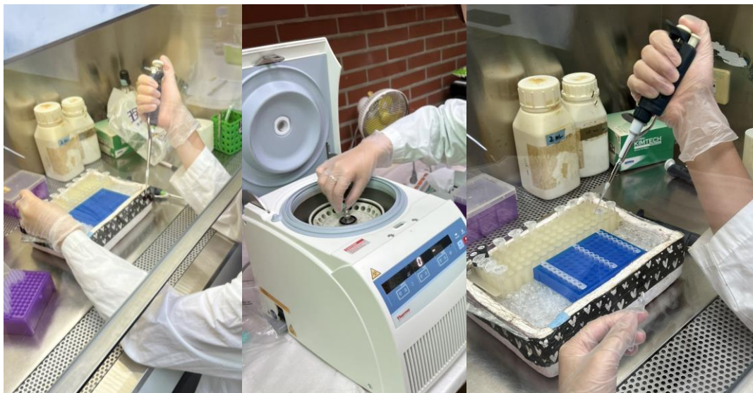
【圖二】左：在離新出的沈積物中加入 Solution1 中：使用離心機以均勻混合 右：使用乙醇洗滌
