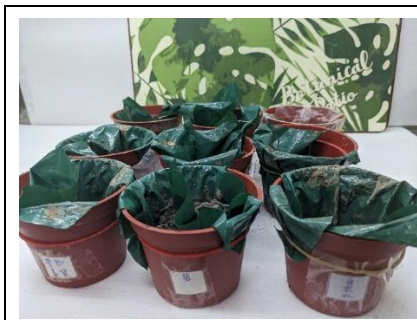
PLA 塑膠杯分解實驗圖
